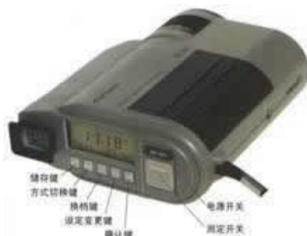
本公司采用日本 CHINO 公司国际先进水平的 IR-AHS0 型红外测试仪系统。该产品便于携带，可自动记录物体表面的温度，测温范围为 600~3000℃，精度可达±0.5%±1digit，分辨率为 1℃，应答时间 0.5 秒。最多可以存储 1000 个温度数据，并可由 LCD 显示屏显示出来。存储的温度数据可通过 RS-232C 串口与计算机进行通信，从而通过 Windows 专用软件对测温仪中的温度数据进行处理分析。
